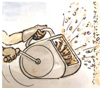
Projection à la main et projection mécanique à la « tyrolienne ».
